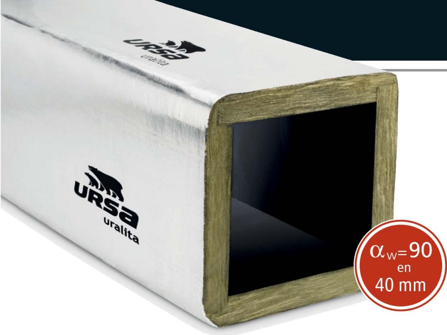
URSA AIR Zero Q4 es un panel de lana mineral, revestido por su cara exterior por un complejo kraft-aluminio reforzado, y por su cara interior por el tejido acústico de color negro Zero.
