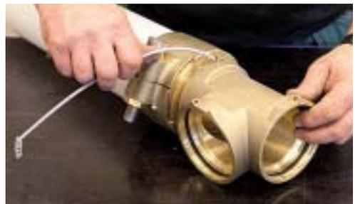
6.- Por último, fijar la unión mediante el pin de goma de cierre hasta escuchar un "click".
