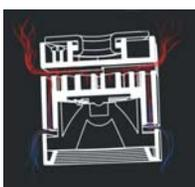
Gracias a la tecnología de disipación pasiva **Lledó ICC**, Zirconic garantiza las 50.000 horas de vida de su fuente de luz LED de alta intensidad de 4W
